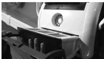
7. Työnnä suodatinkotelo takaisin allasrobottiin uraa pitkin
