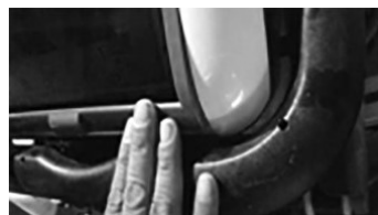
8. Paina kädensijan molemmilta puolilta niin, että kotelo menee kiinni
